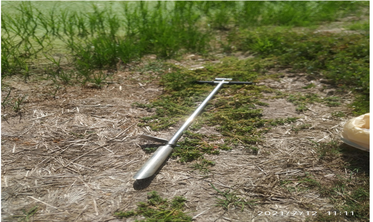
Foto nº 3: Barrena en acero inoxidable 316 con limitador de profundidad para la realización de las calicatas.
